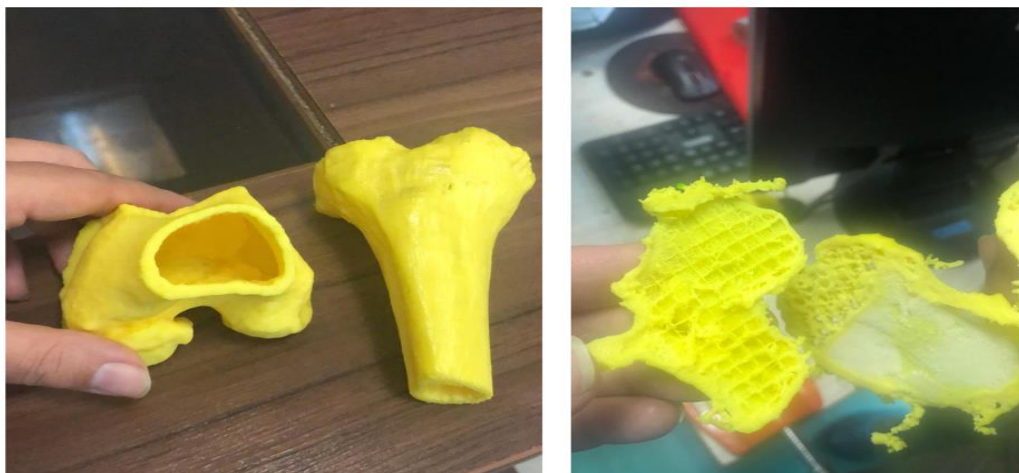
شکل ۲. استخوان‌ها به وسیله‌ی پرینت سه بعدی ساخته شدند و در آنها کورتکس از جنس PLA و مدولای استخوان از جنس رزین پدیلن ساخته شد.
